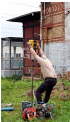
Baugrunderkennung durchgeführt durch das Büro für Geotechnik & Ingenieurgeologie Holger Baumann im September 2008.
